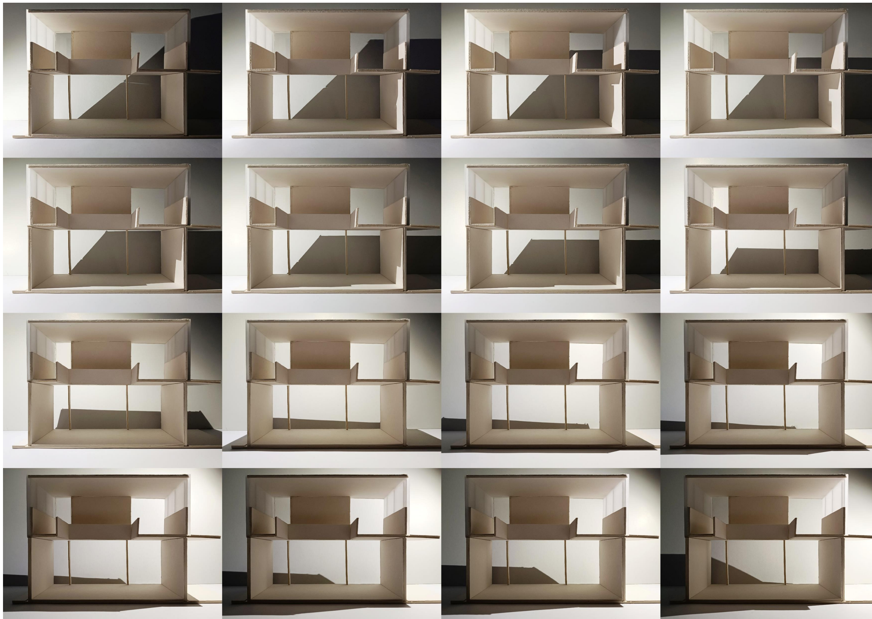
MAKETT BENAPOZÁSVIZSGÁLATA M=1:50 STT KOLOZSVÁR TRANZIT HÁZ MÓDLY EMŐKE KLOBUSOVSZKI PÉTER DLA 2022.12.16.
