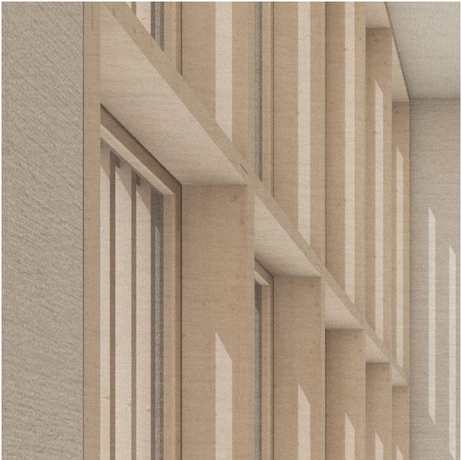
lamellás árnyékolt fa szerkezetű függönyfal a déli belső homlokzaton
