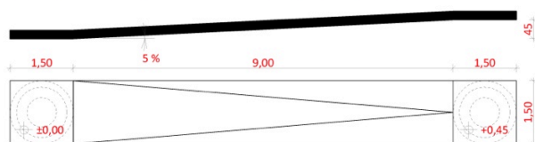
akadálymentes rámpa 17 cm-nél nagyobb szintkülönbség áthidalásához
