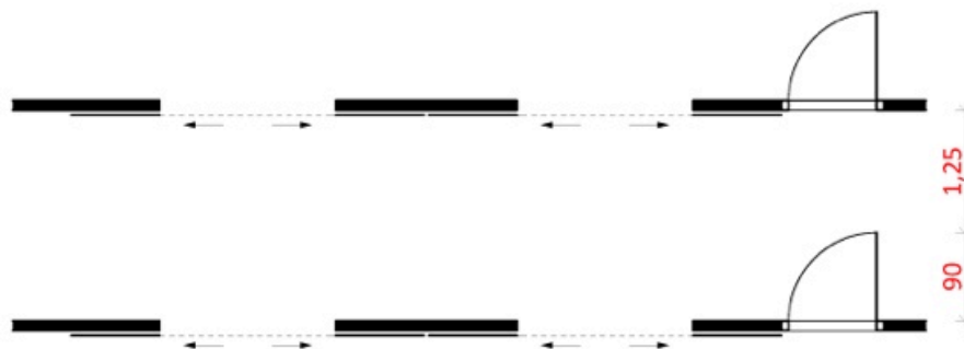
nagyméretű tolóajtós szélfogó menekülőajtóval
