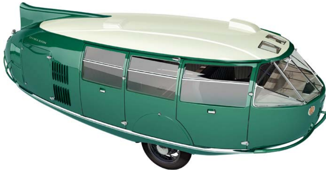
R. Buckminster Fuller, Dymaxion Car ,1933, Chicagói Világkiállítás 11 személy, fogyasztás 7,8 l, áramvonalas forma
